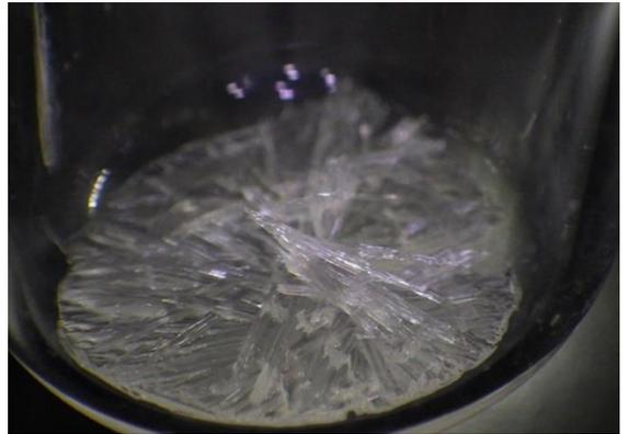
図2. 分子結晶電解質 $\text{Li}(\text{FSA})(\text{SN})_2$ の外観
