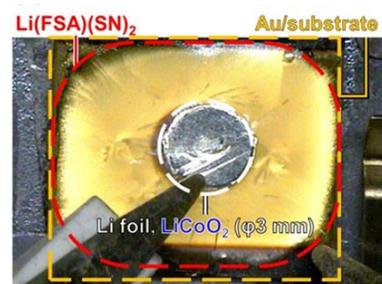
図4. 分子結晶電解質Li(FSA)(SN)<sub>2</sub>を用いて作製した薄膜全固体電池(Li|Li(FSA)(SN)<sub>2</sub>|LiCoO<sub>2</sub>)の模式図と外観
